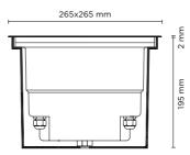
HOLE FOR RECESSING 257x257 mm
