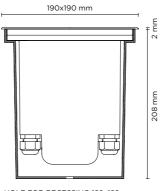
HOLE FOR RECESSING 182x182 mm
