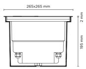
HOLE FOR RECESSING 257x257 mm
